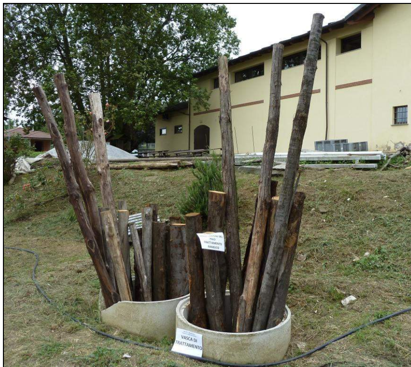
Fig.9 – Serbatoi utilizzati per l’immersione della base dei pali nella soluzione concentrata di solfato di rame.
