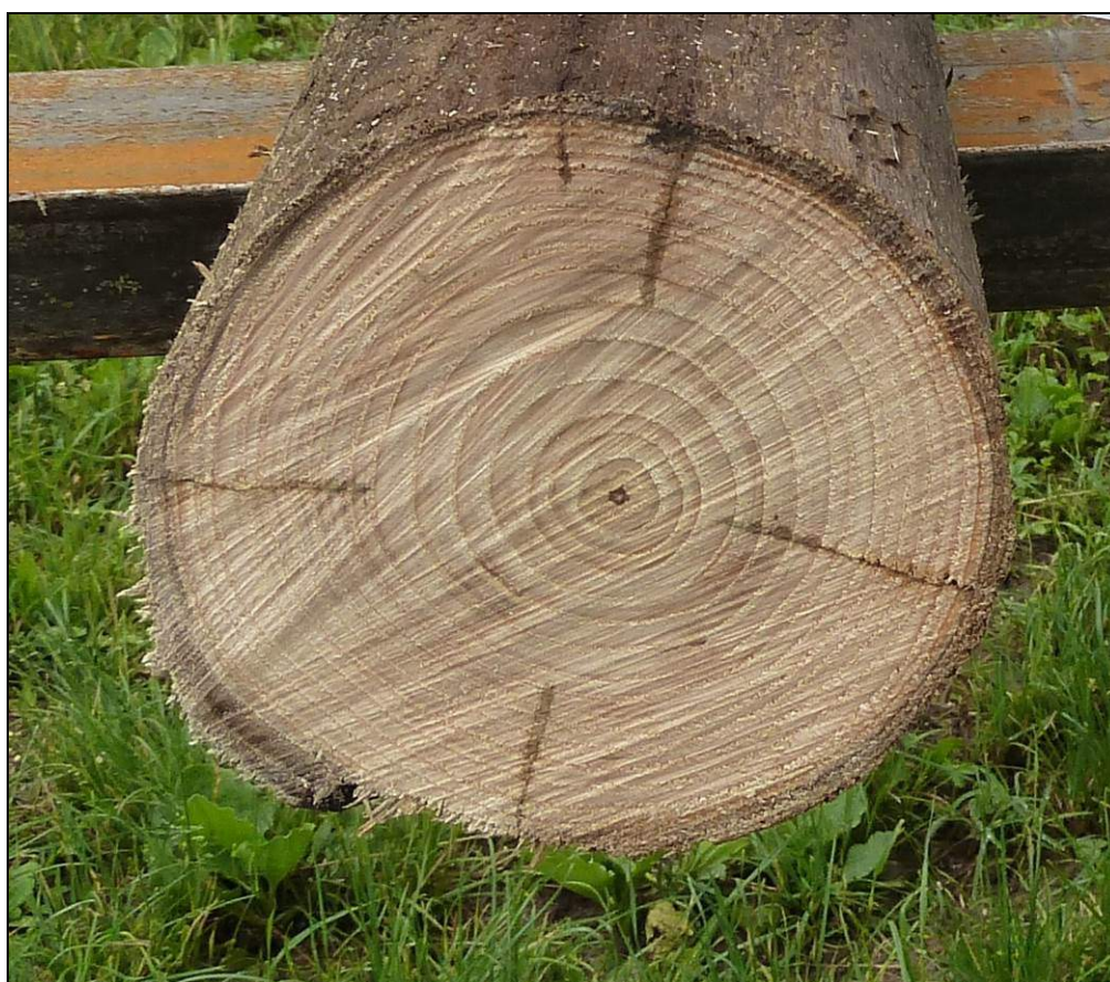
Fig.10– Sezione trasversale di un palo di castagno dopo 15 gg di immersione in soluzione rameica .
