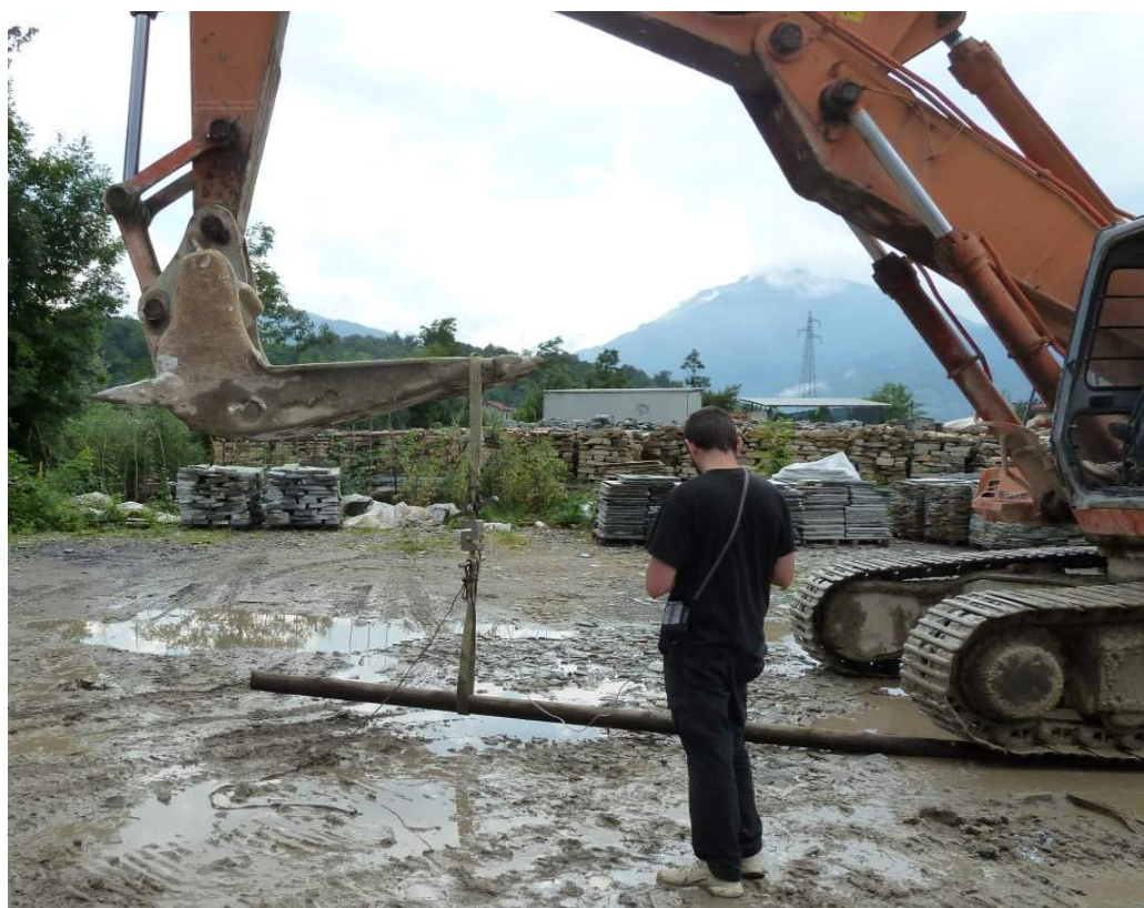
Fig. 11- Esecuzione delle prove per la verifica della resistenza meccanica alla flessione
