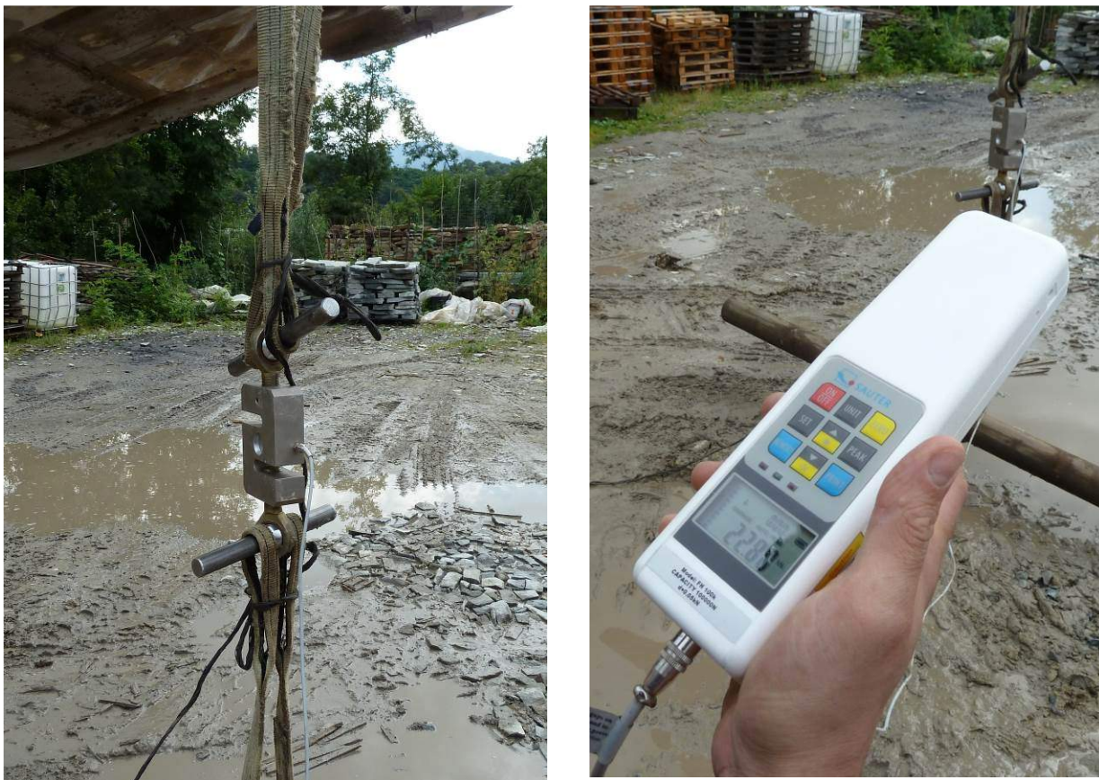
Fig. 12 – Particolari del dinamometro digitale utilizzato per rilevare il carico di rottura
